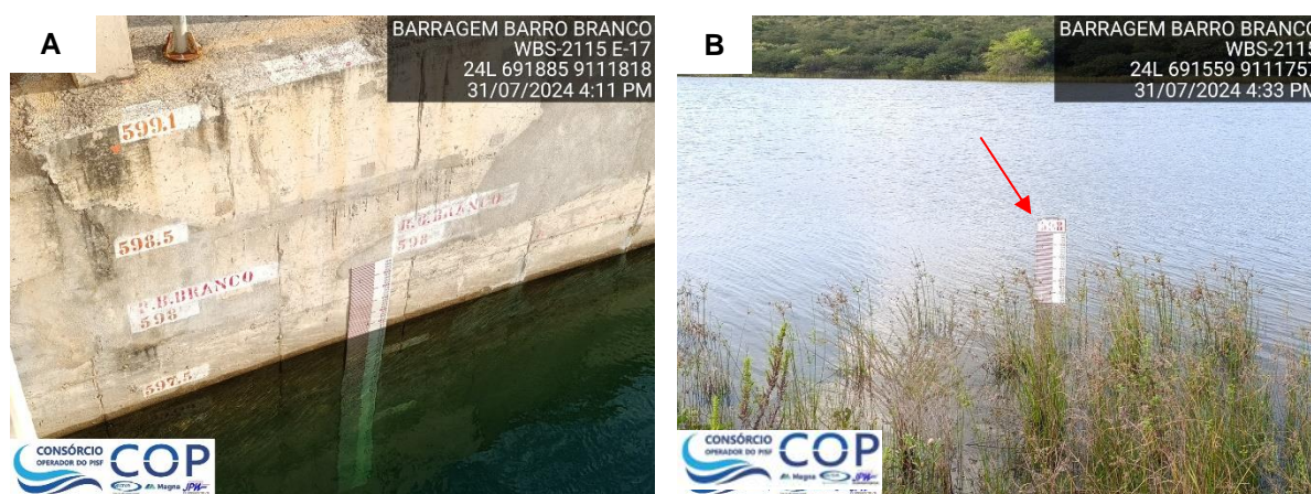
Foto 7.1: Disposição das réguas linimétricas, instaladas na torre da tomada d'água (A) e na área do reservatório (B).
